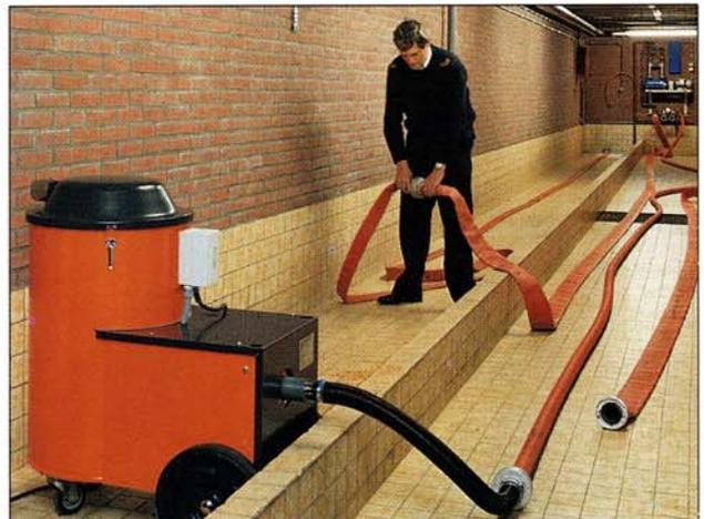
▲ Secado de mangueras de bomberos mediante el aire caliente soplado por la máquina aspiradora.
