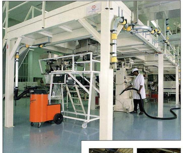
▲ El C 335 utilizado como central de aspiración con conexión a una red de tubería fija en una industria alimentaria
