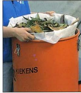
▲ Uso del filtro principal PNV en combinación con una bolsa desechable visto de poliéster poroso que hace a la vez la función de pre-filtro. El filtro PNV se ensucia menos y se facilita la evacuación del polvo.
