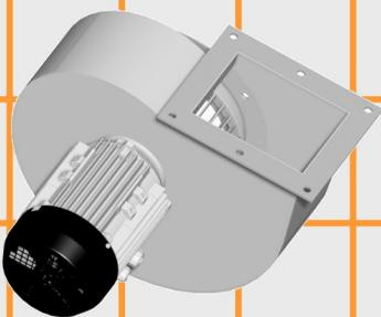
Potente ventilador centrífugo. Caudal de aire variable a través de un potenciómetro para una óptima regulación del régimen de trabajo y eficiencia. Un manómetro diferencial controla el estado de colmatación de filtros.
