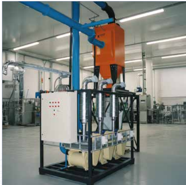
Turbinas de alto vacío Kieken instaladas en bastidor con colector común.
