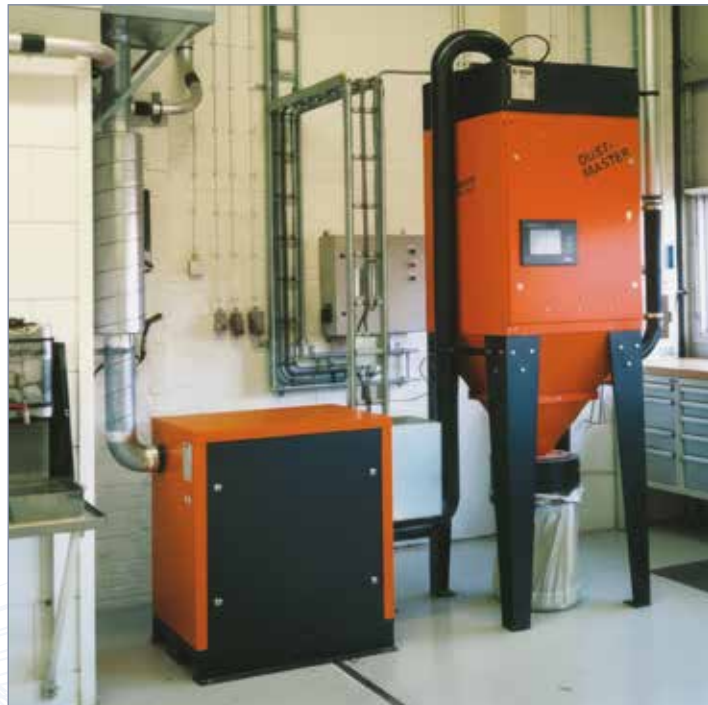
Equipo de filtración Dustmaster conectado a turbina de alto vacío en caja acústica.
