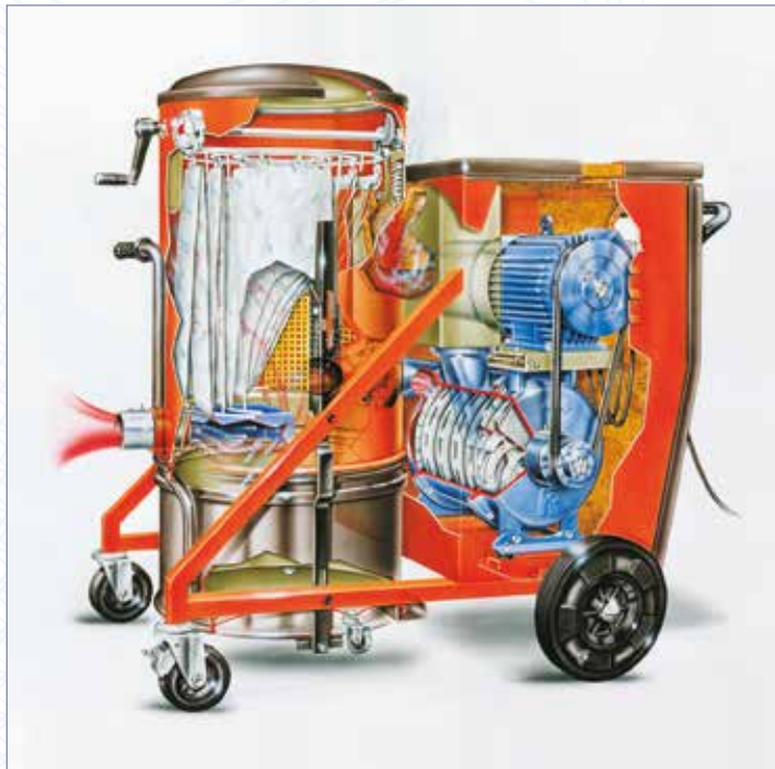
Turbo-compresor instalado como unidad central de uno de nuestros aspiradores.
